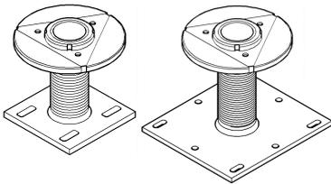
Unterkonstruktion des Dichtteils zur Überbrückung der Wärmedämmung. Die Unterkonstruktion verfügt über eine form- und kraftschlüssige Niveau-/Höhenausgleichsregulierung zur Aufnahme bauseitiger Toleranzen.
