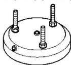
Dichtteil, geeignet zur Montage auf BefTec® Unterkonstruktionen. Zur NACHWEISLICH DICHTEN Durchdringung der Dachabdichtung (Bitumen-, Kunststoff- und Metall-Dachbahnen) und Aufnahme weiterer Systemkomponenten bzw. Konstruktionen. Inkl. Prüfeinheit zum Nachweis der Dichtheit. Zum Höhenausgleich von Dachgefälle bzw. Gefälledämmung oder hohen Fußbodenaufbauten sind längere Gewindestangen zu beachten!
