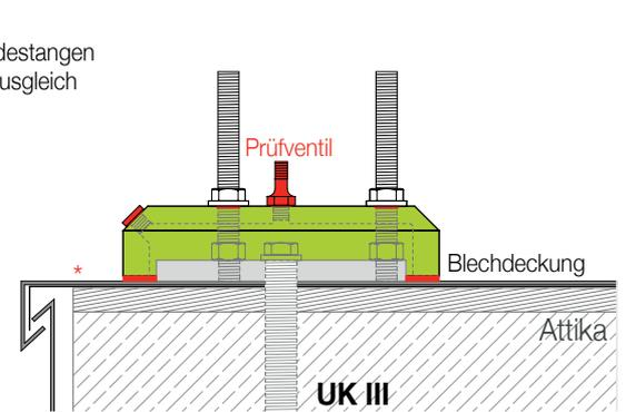
\* Dachabdichtung = Bitumen | Kunststoff
